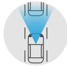
Le SYSTÈME D'ALERTE PRÉDICTIF anticollision frontale garde un œil sur les deux véhicules devant vous. Lorsque le système détecte un ralentissement soudain, une alerte visuelle et sonore se déclenche, vous permettant ainsi d'anticiper votre freinage.
