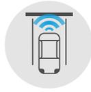
Le FREINAGE D'URGENCE INTELLIGENT détecte les véhicules, piétons ou cyclistes qui se trouvent devant vous. Il vous alerte en cas de risque de collision à basse vitesse et si nécessaire, vous aide à réduire votre vitesse en actionnant les freins. Il détecte également les intersections et vous aide ainsi à éviter les collisions aux croisements.
