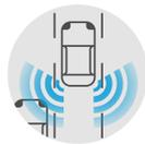
Avec le FREINAGE D'URGENCE ANTICOLLISION ARRIÈRE, effectuez vos marches arrière en toute confiance. Si un objet statique est détecté derrière votre véhicule, le système freine automatiquement afin d'éviter la collision.
