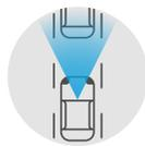
Le SYSTÈME DE PRÉVENTION DE FRANCHISSEMENT DE LIGNE INTELLIGENT vous aide à rectifier tout dépassement de ligne involontaire. Il peut actionner légèrement les freins pour vous remettre dans la voie en cas d'urgence. Il agit en combinaison avec le SYSTÈME DE SURVEILLANCE DES ANGLES MORTS INTELLIGENT.
